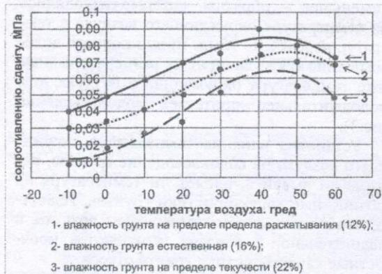
Рис. 4. Зависимость сопротивления грунта сдвигу от температуры воздуха
